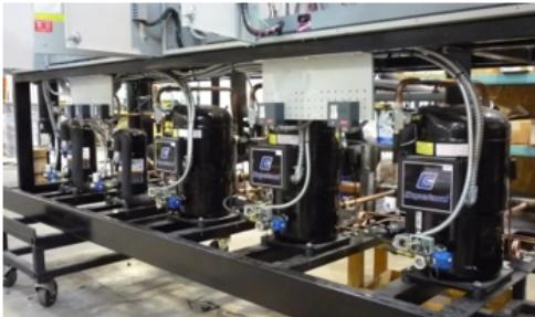
大型冷藏庫或超市冷藏櫃常將併聯，使用冷媒壓縮機組Refrigeration Rack System，依據負荷調整開關壓縮機，並使用反向型壓縮機處理最少量的負荷。
